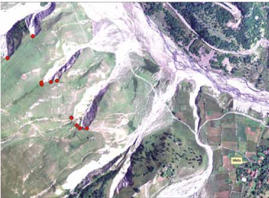
■ Abb. 6: Kartierung von Muranrissen in der Untersuchungsregion Kazbegi mit Hilfe von Satellitenbildern.
