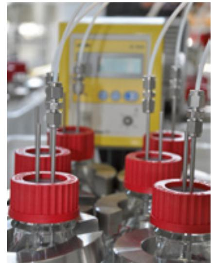
■ Abb. 2: Probengefäße aus Glas zur Inkubation der Bodenproben. Diese werden über Nylonschläuche an die Messanlage angeschlossen.
