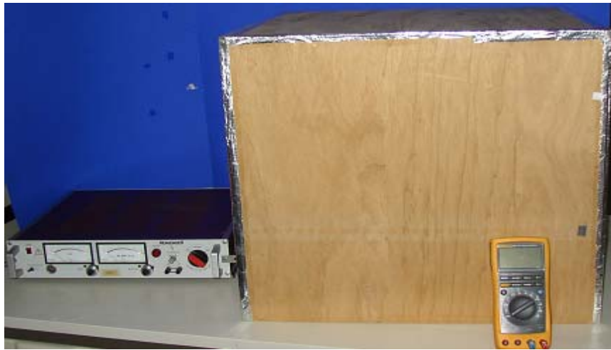
Abb. 4.5.1: Apparatur unter der Holzkiste mit Hochspannungsgerät (links) und Voltmeter (vorne)
